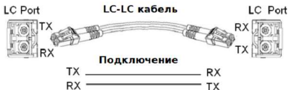
Рис. 9. Подключение оптического кабеля к оптическому трансиверу
