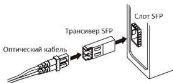
Рис. 10. Подключение оптического трансивера SFP
